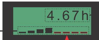
Indica a quantidade de horas de funcionamento do equipamento.
